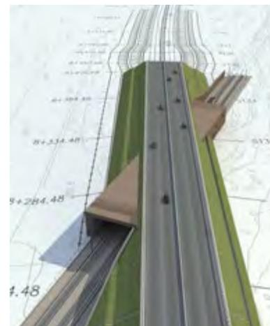
simulazione tridimensionale attraversamento linea ferroviaria
